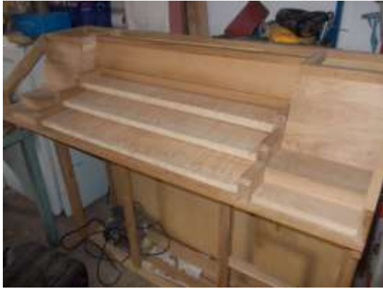
Fig. 4. Stadiul intermediar de construcție a consolei
