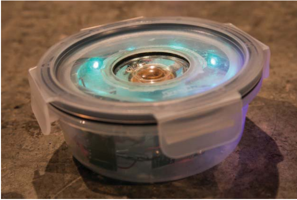
Figura 3: Prototip iluminat cu leduri în carcasă transparentă și boxă cu membrană transparentă (copyright Theo Stenert)
